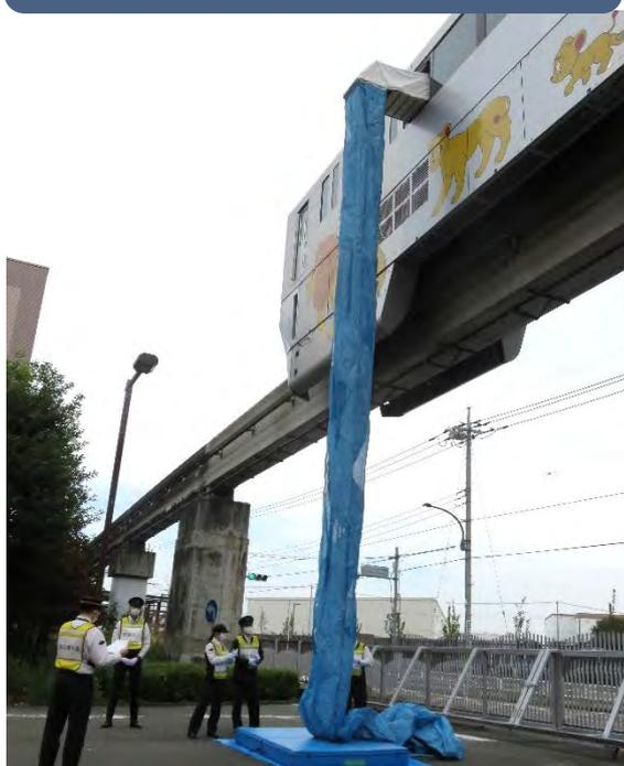
横取り装置や列車連結による救出が行えない場合に、脱出シューターを使用して列車から地上に降りていただく方法です。火災などの際に避難する器具としてビルなどで使用されているもので、車両客室の窓からシューター部分を地上に下ろし、筒状のシューター内をお客様がらせん状に滑り降りるものです。
