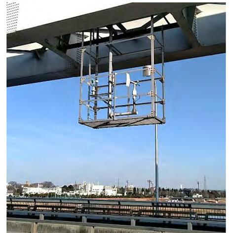
多摩川の風速計と風向風速計
